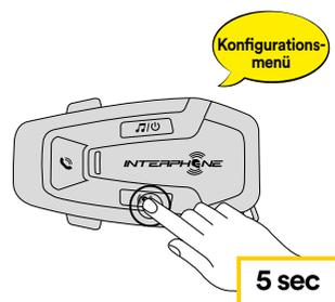
Rufen Sie bei eingeschaltetem U-COM 6R das Konfigurationsmenü auf, indem Sie die Taste INTERCOM 5 Sekunden lang drücken. Lassen Sie die Taste erst los, wenn die LED blau leuchtet, dann hören Sie die Meldung, die die Aktivierung des Konfigurationsmenüs bestätigt.
