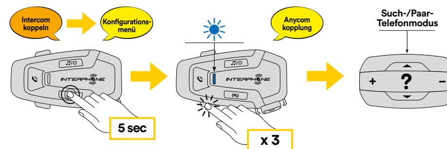
1. Rufen Sie bei eingeschaltetem U-COM 6R das Konfigurationsmenü auf, indem Sie die Taste INTERCOM 5 Sekunden lang drücken. Lassen Sie die Taste erst los, wenn die LED blau leuchtet.
