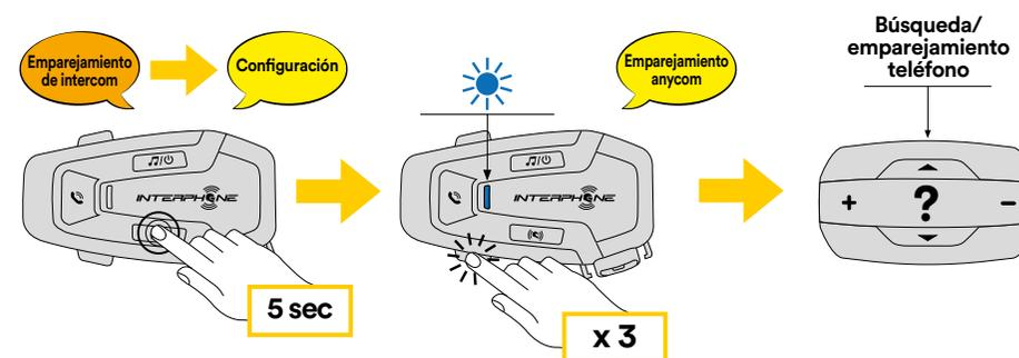
1. Con el U-COM 7R encendido, entre en el menú de configuración pulsando el botón INTERCOM durante 5 segundos. No suelte el botón antes de que el led se vuelva azul.
