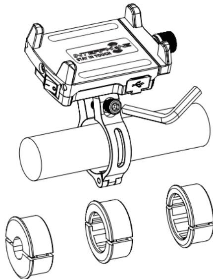
Diametri compatibili: da 12 a 32 mm, se necessario utilizzare i distanziali plastici in dotazione.
